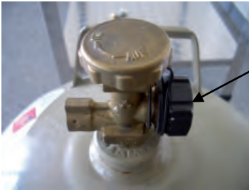
Abb. 41: Flüssiggasflaschen-Absperrventil mit aufgeschraubter Ventilverschlussmutter
