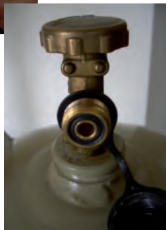
Abb. 16: Beispielhaftes Druckregelgerät (mit integrierter Überdrucksicherheitsvorrichtung) mit Kombinationsanschluss sowie Dichtring - Einsatz nur mit Dichtring, unabhängig vom Dichtsystem der Flasche (z. B. 5-kg-, 11-kg-, 33-kg-Flasche)
