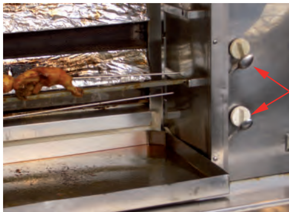
Abb. 32: Grillgerät eines Hähnchengrillwagens mit manipulierten Ventilen
