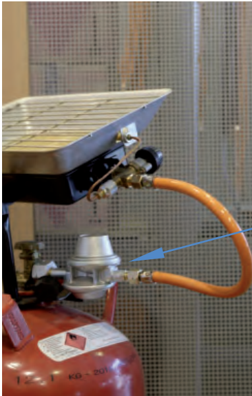
Abb. 25: Erforderliche Sicherheitseinrichtungen (hier: Druckregelgerät mit integrierter Überdrucksicherheitseinrichtung) für die Benutzung von Gasgeräten mit Schlauchleitungen bis maximal 0,4 m (Beispiel: Infrarotstrahler), Betrieb im Freien
