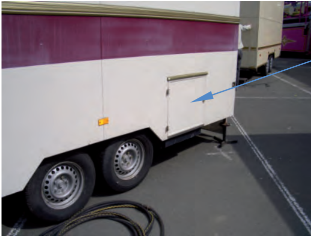
Abb. 37: Von außen zugänglicher Kasten (Schränk) für Flüssiggasflaschen
