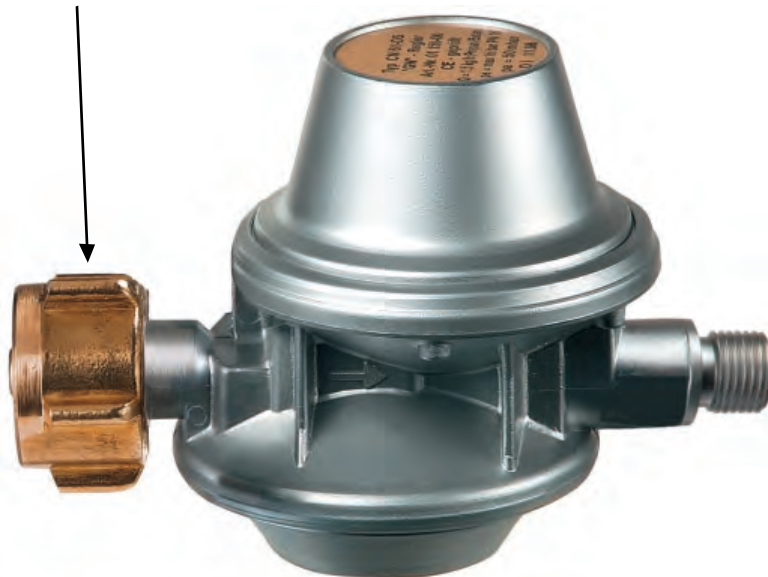
Abb. 9: Beispielhaftes Niederdruckregelgerät für Kleinflaschenanlagen bis 14 kg Füllgewicht mit integrierter Überdrucksicherheitseinrichtung
