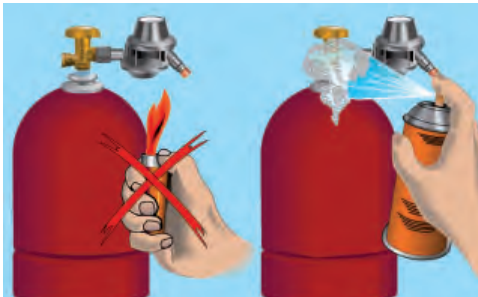
Abb. 17: Dichtheitsprüfung mittels Lecksuchspray
