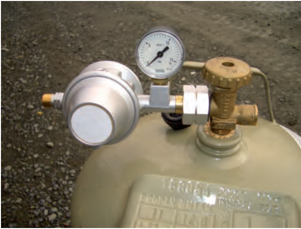
Abb. 31: Beispielhaftes Druckregelgerät mit integrierter Überdrucksicherheits-einrichtung und Manometer zur Dichtheitskontrolle
