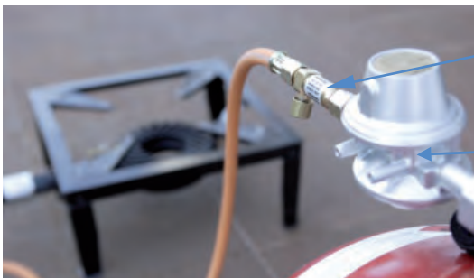
Abb. 26: Erforderliche Sicherheitseinrichtungen (hier: Druckregelgerät mit integrierter Überdrucksicherheitseinrichtung und Schlauchbruchsicherung) für die Benutzung von Gasgeräten mit Schlauchleitungen länger als 0,4 m (Beispiel: Hockerkocher), Betrieb im Freien
