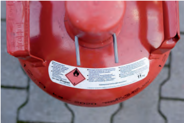
Abb. 52: Kennzeichnung Flüssiggasflasche (Gefahrgutaufkleber)
